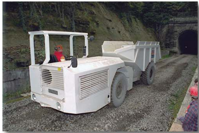
Materialtransport mit Muldenkipper Paus Typ ITC 8000.
