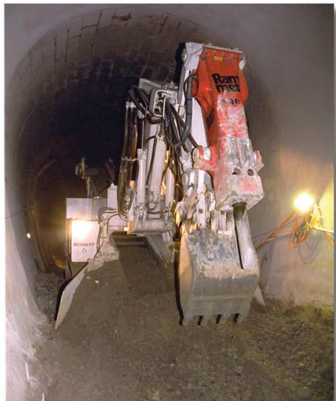
... sekundenschneller Wechsel zwischen Hammer und Löffelbetrieb
