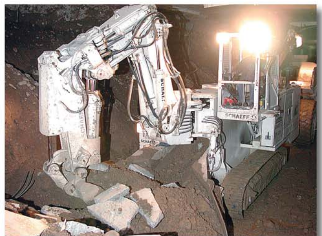
Überladen auf 25 t - Muldenkipper
