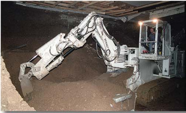
Hohe Ladeleistung mit bis 5 m 3 /min
