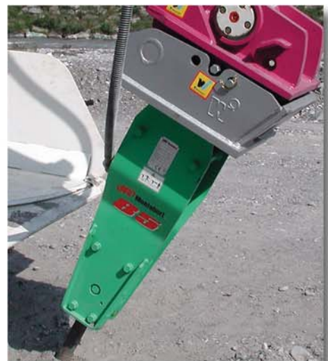
Hammer zum Absichern auf Schnellwechsler
