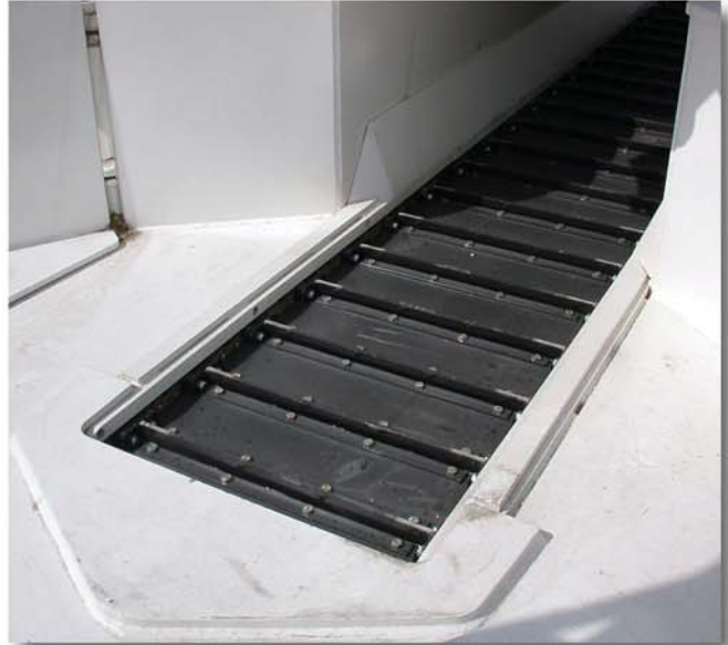
Hohe Förderkapazität dank Gummi-Plattenband
