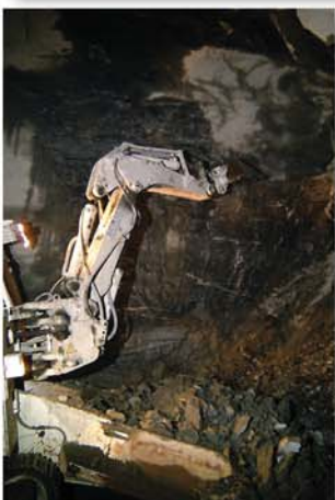
Die Lademaschine beim Bereissen
