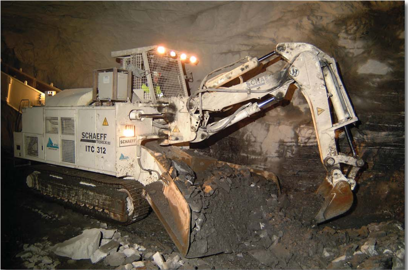
Die Lademaschine Schaeff Typ ITC 312 beim Sohlenreinigen in 1:8 Steigung
