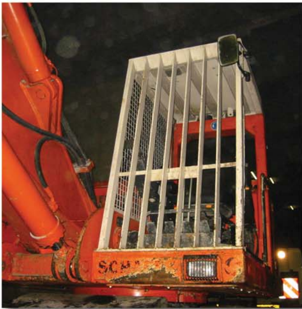
Der Tunnelbagger Typ TE 200 im Tunnelquerschnitt 37 m 2 , Firsthöhe 6 m
