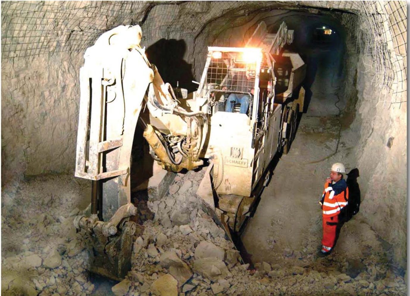
Die Tunnellademaschine Typ ITC 312 H3 in Ladeposition im Hauptstollen
