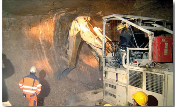
Berauben der Orstbrust in sehr sicheren Bedingungen
