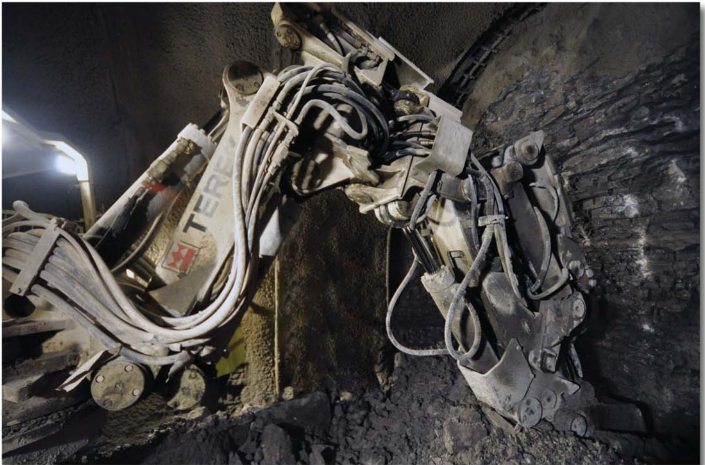
Abb. 1: ITC 120 F2 im Hammervortrieb
