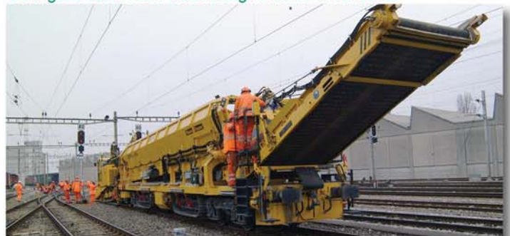
Geringer Platzbedarf dank integriertem Förderband
