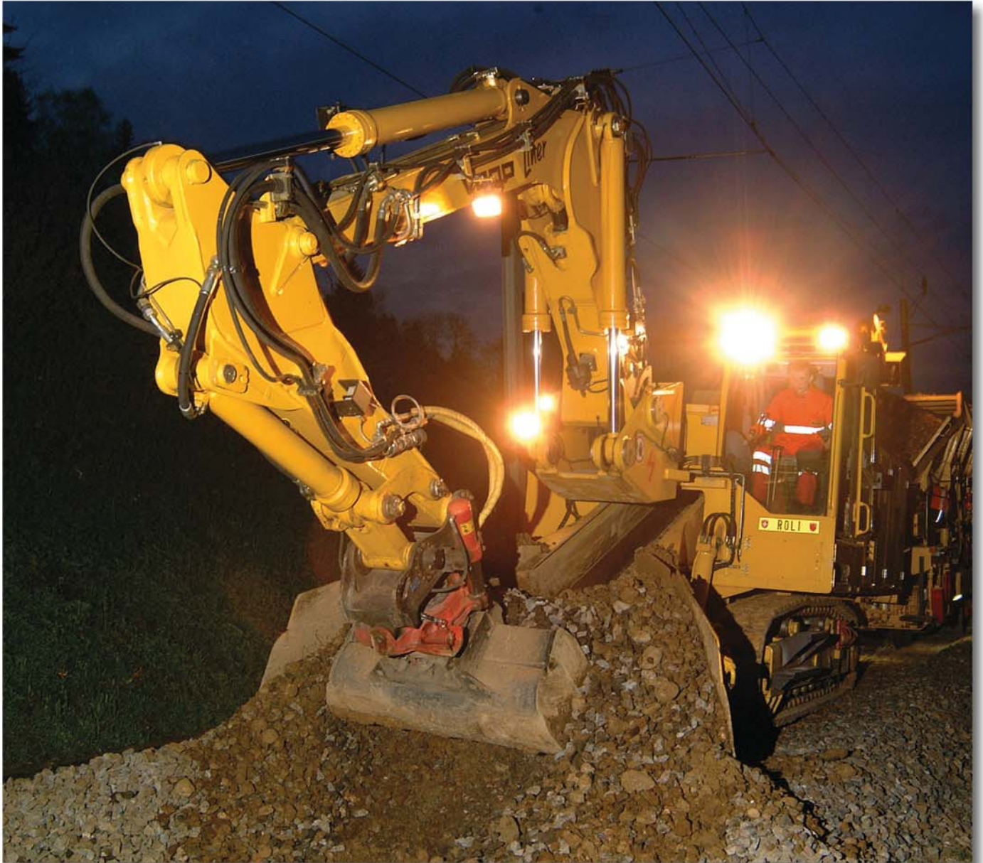
Die Ballast-Lademaschine Schaeff Typ ITC 312 VL2 mit dreiteiliger Arbeitseinrichtung in Ladeposition
