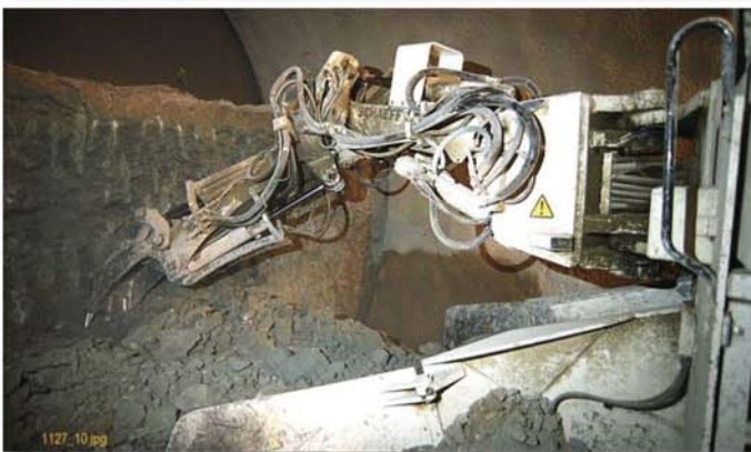
Abb. 12: ITC 312 beim Lösen des harten Mergels
