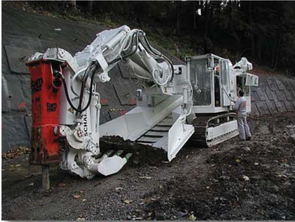
Abb. 10: ITC 420 im Südvortrieb
