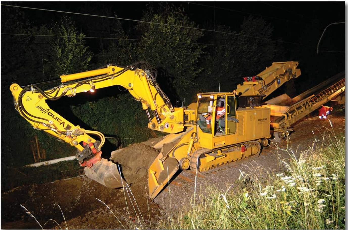
Die Ballast-Lademaschine Schaeff Typ ITC 312 Vanoliner mit dreiteiliger Arbeitseinrichtung in Ladeposition
