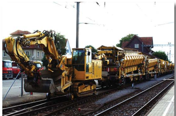
Maschine auf pony truck geschleppt (Schienenfahrwerk)
