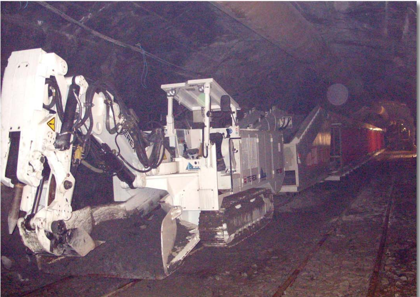
Die Tunnellademaschine Typ ITC 120 F6 in Garnitur mit dem Nachläufer
